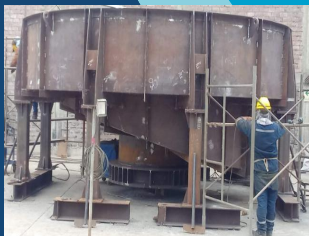
FABRICACIÓN DE LAUNDER CYCLON
