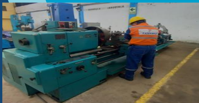
TORNO HORIZONTAL VOLTEO 900 X 2500 MM
