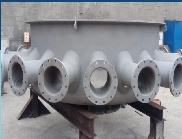
REPARACIÓN DE DISTRIBUIDOR A CICLONES
