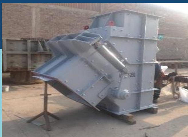
FABRICACIÓN DE CHUTE REVESTIDO EN HARDOX
