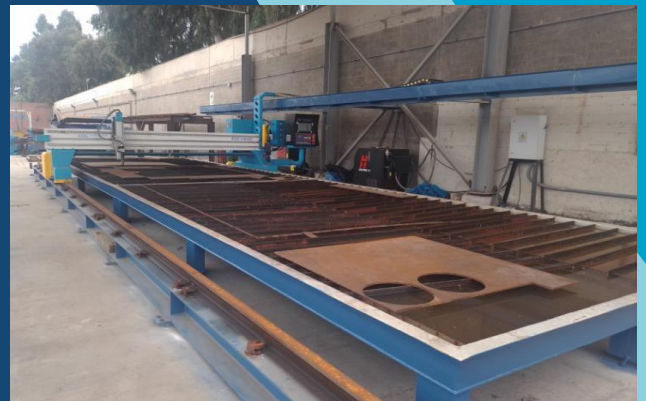
MESA DE CORTE CNC DIM. 3000 MM. X 12000 MM.
