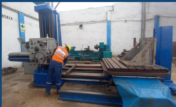
MANDRINADORA HORIZONTAL / W 100A PARA PIEZAS DE HASTA 3000 KG.
