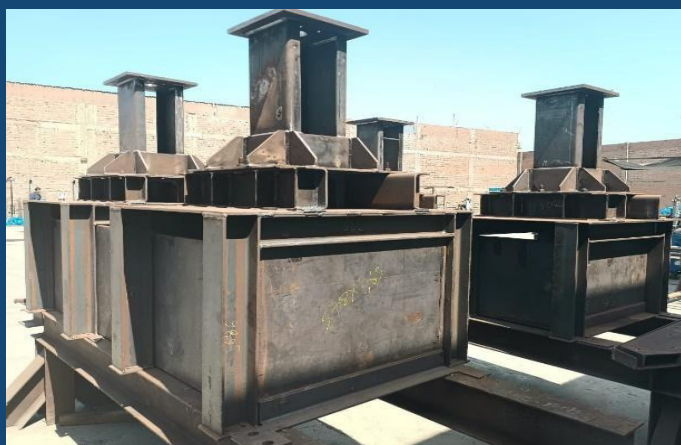
FABRICACIÓN DE CAJONES VÁLVULAS DARTO MINERA COLQUISIRI
