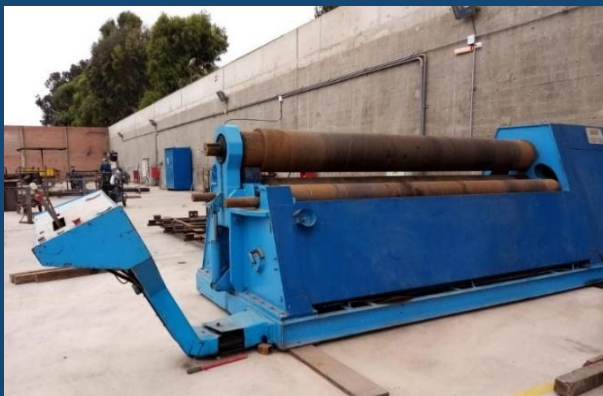
ROLADORA DE PLANCHAS ESPESOR MAX. A ROLAR 25 MM x 3M
