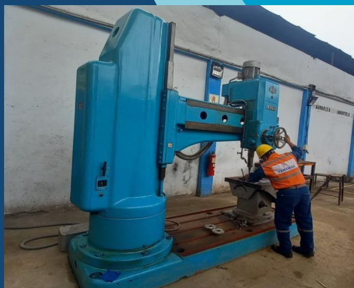
TALADRO RADIAL MODELO: VRGA KOVOSTI CONO MORSE: 5 LONGITUD DE BANDERA: 2000 MM. CARRERA VERTICAL: 950 MM.
